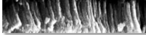
Şekil 3.7.b Aşındırma işlemi \text{NaBH}_4 deneyi uygulanmış filmin SEM kesit görüntüsü (Ru kaplama gücü: 50 W, Cu kaplama gücü: 200 W)
