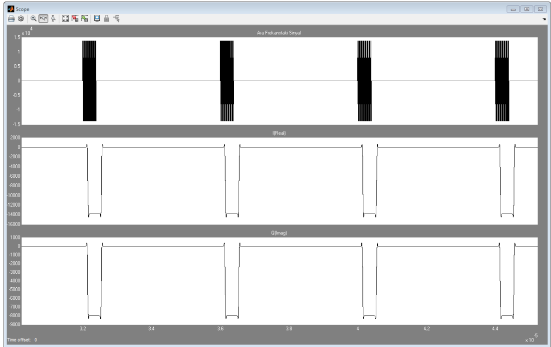
Şekil 3.14. Ara frekanstaki ve taban banttaki sinyallerin zaman eksenindeki görüntüsü
