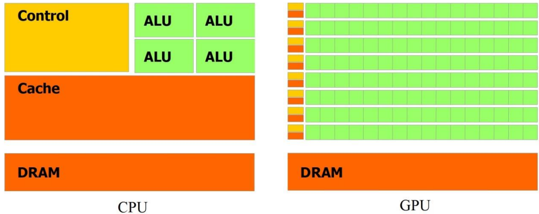
Şekil 2.3. CPU ve GPU mimarileri arasındaki farklar
