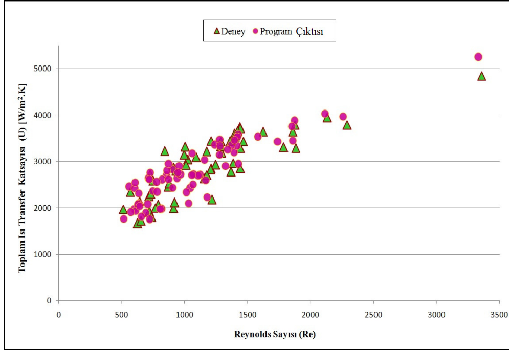
Şekil 5.23. Levha 1 ile Yapılan Deneyler ve Program Hesabı ile Elde Edilen Toplam Isı Transfer Katsayısının Reynolds Sayısı (Re) ile Değişimi
