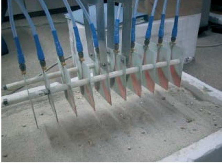
Şekil 2.6: 10 adet Vivaldi antenli multi-statik dizilim[28]
