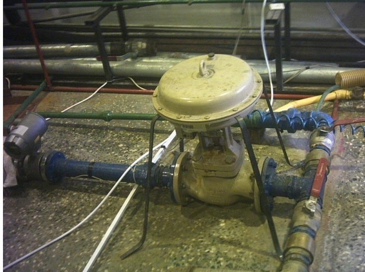
Şekil 2.7. Fisher kontrol vanası ve Toshiba akış ölçer
