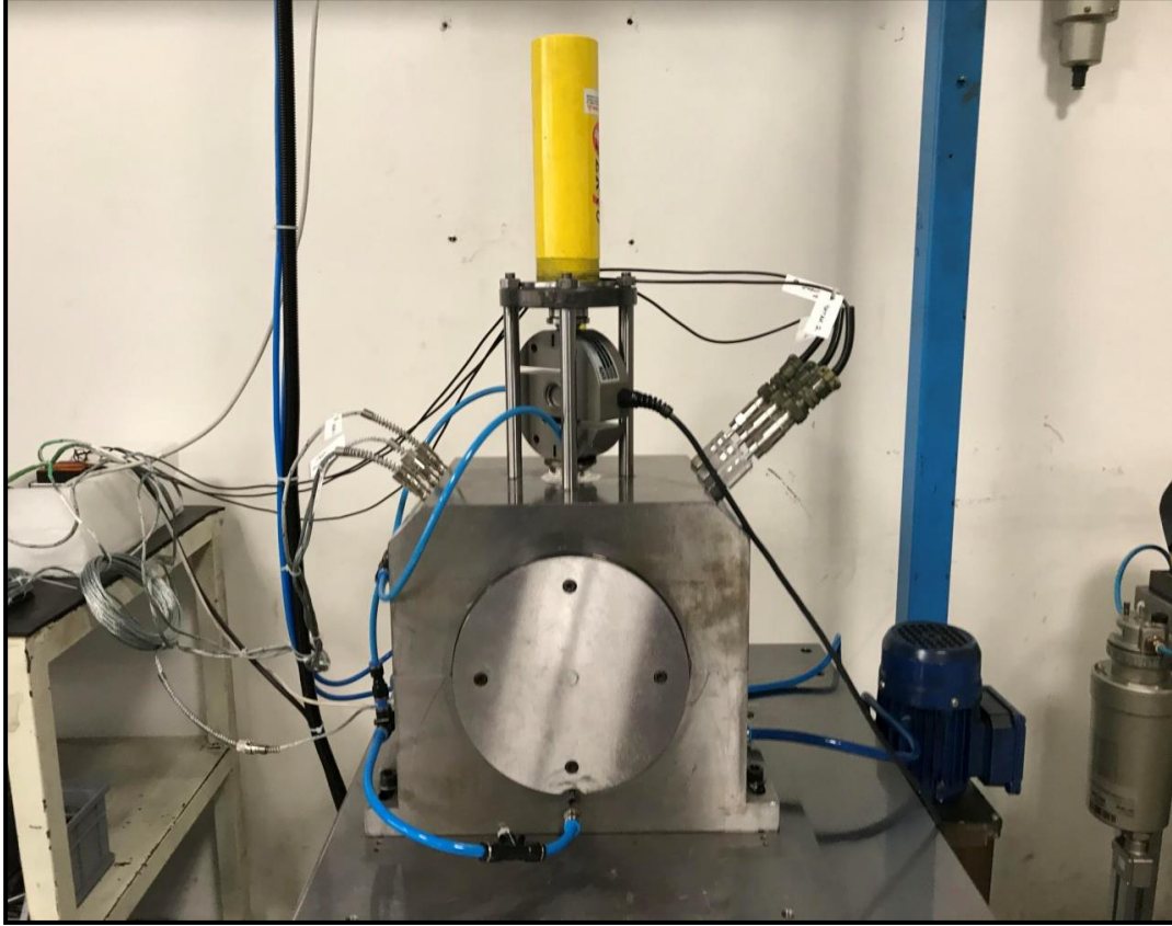
Resim 7.1: NJ309 Silindirik masuralı rulman ömür test aparatı
