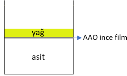
Şekil 2.7: Yağ-asit arayüzünde AAO filmlerin aşındırma işlemi gösterimi
