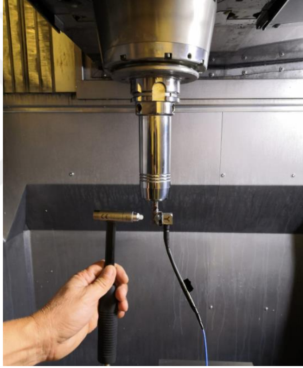
Şekil 3.2: Çekiç testi esnasında çekiç ve ivmeölçerin yerleşimi
