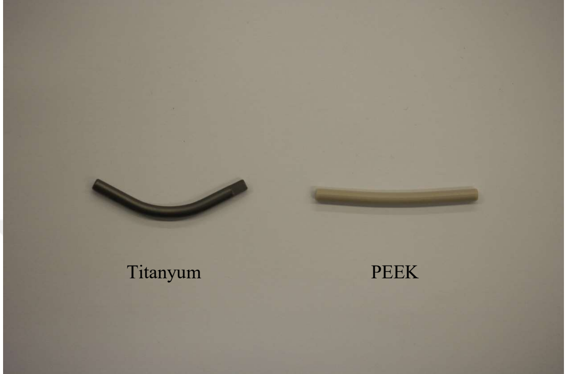
Resim 5.3 : Çubuklardaki kalıcı deformasyon
