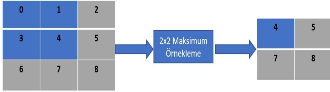
Şekil 2.9: Maksimum değer havuzlama uygulaması
