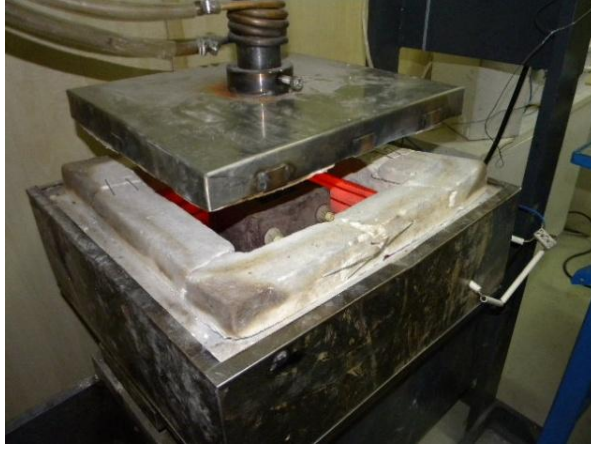
Şekil 3.1 Eş zamanlı olarak gerçekleştirilen sıkıştırma ve sinterleme işlemlerinin gösterimi
