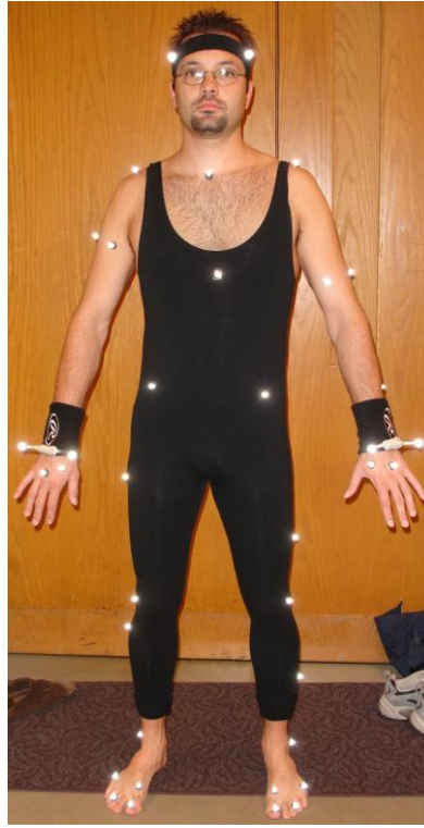
řekil 2.2 İřaretçiler bağlanarak hareket yakalama sistemi ile veri kaydı yapılacak olan denegin görüntüsü [36]
