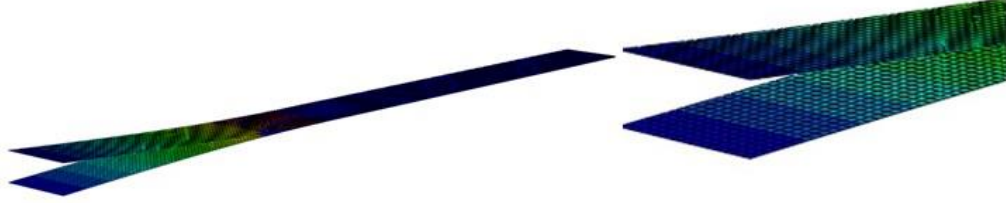
Şekil 4.3 : ÇAK problemi için oluşturulan kabuk elemanlar.
