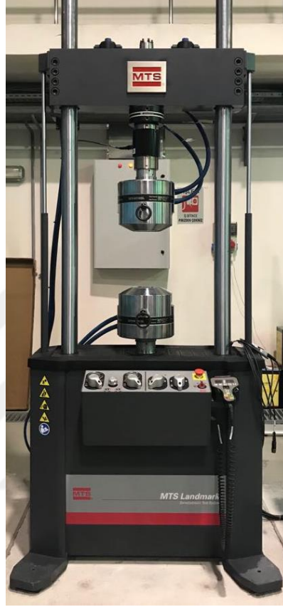
Şekil 5.5 : 250 kN yük kapasiteli hidrolik servo kontrollü MTS eksenel yükleme makinesi.
