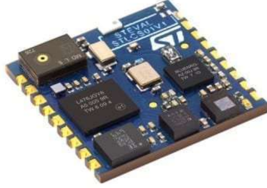
Resim 3.1 : STEVAL-STLKT01V1 (Sensortile) geliştirme kartı
