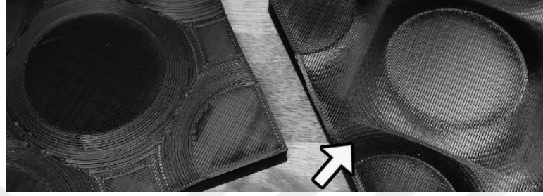
Figür 2.1. Düzlemsel Olmayan Ü Boyutlu Yazıcı İle Yüzey Kalitesi (Naramore, 2019)
