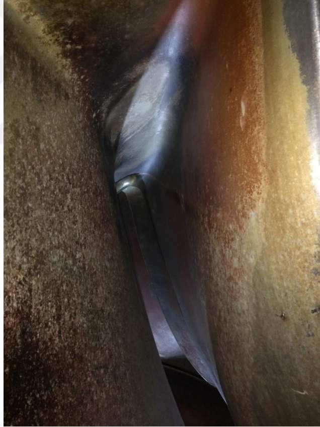
Şekil 4.41: Kanatlar arası girdabın tamir edildiğini gösteren saha görseli.
