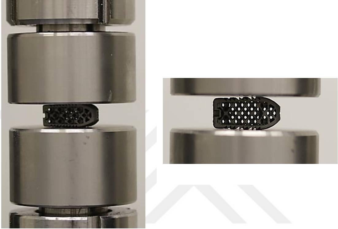
Şekil 6.5: Deneysel başlamadan önce numunenin yerleştirilmesi.
