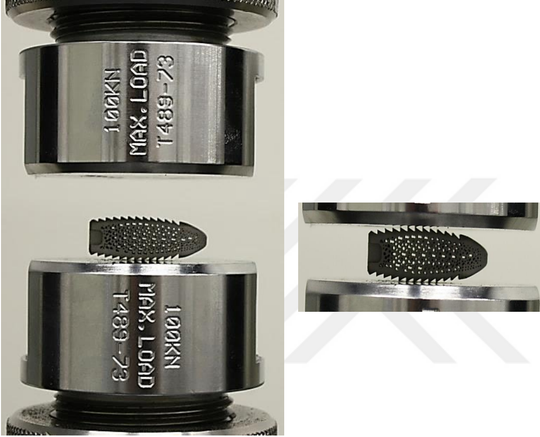
Şekil 6.7: Deney başlamadan önce numunenin yerleştirilmesi.
