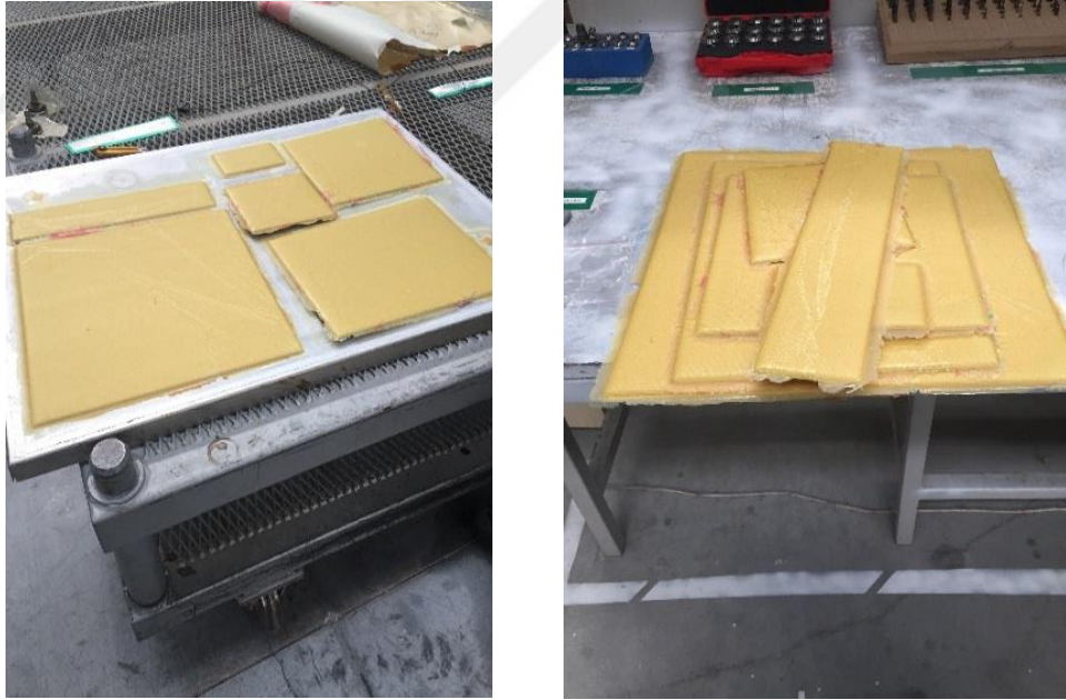
Şekil 3.1.1.4 : Otoklav işlemi tamamlanmış olan AFRP kompozitler.
