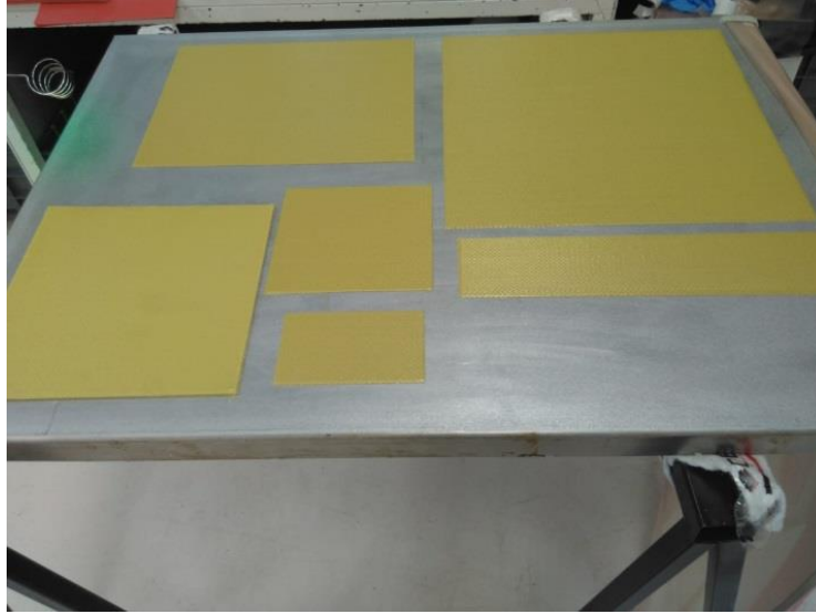
Şekil 3.1.1.1 : Serim işlemine hazır aramid fiber pre-preg katmanlar.
