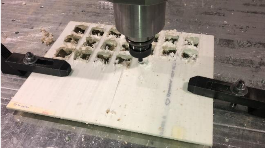
Şekil 3.2.2.2.1 : UHMWPE cep açma operasyonu.
