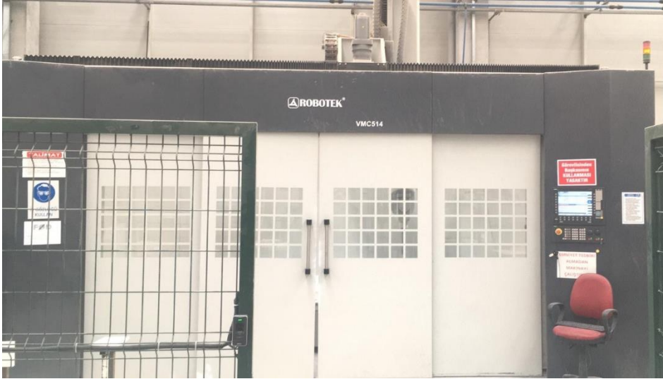
Şekil 3.2.1 : Talaşlı imalat deneylerinin gerçekleştirildiği Robotek marka CNC işleme merkezi
