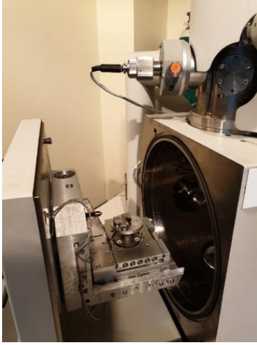
Şekil 3.4.1 : SEM cihazına girmeden önce yapılan kaplama ve cihaza yerleştirme.
