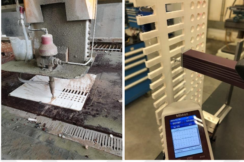
Şekil 3.3.2.2.1 : (a) UHMWPE cep açma operasyonu (b) yüzey pürüzlülüğü ölçümü.
