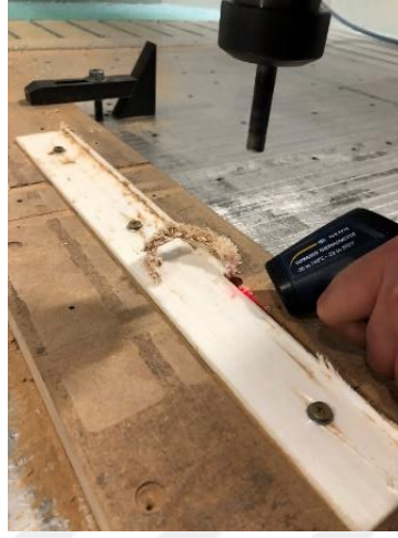
Şekil 3.2.4 : İşlenen yüzeydeki sıcaklık ölçüm görseli.
