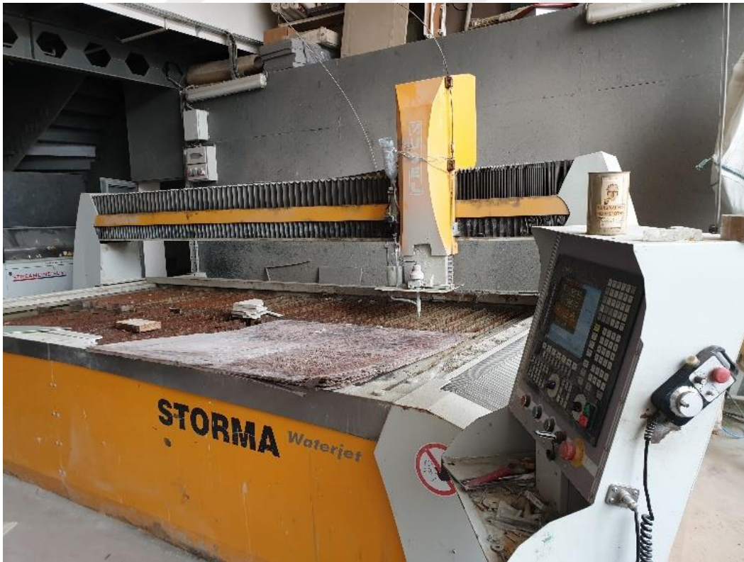
Şekil 3.3.1 : Su jeti kesim operasyonlarında kullanılan Storma marka tezgâh.
