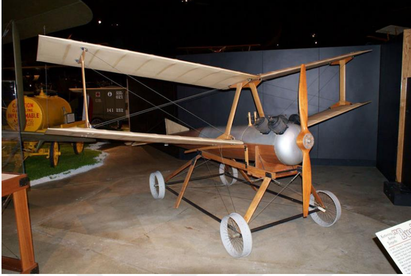
Resim 2.2: Kettering'in torpido uçağı [55]
