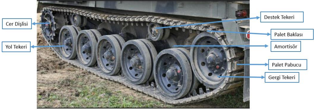
Şekil 3.2: Paletli süspansiyon sistemi parçaları
