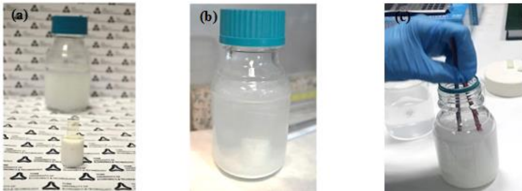
Şekil 2.2 (a) ZnO nano çubuk üretmek için hazırlanan solüsyon görüntüsü , (b) fırın işleminden sonra ki solüsyon görüntüsü, (c) üretilen nano çubukların borosilikat şişesinden alınma görüntüsü.
