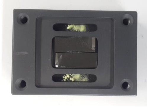
Şekil 4.2 Sülfürleme işleminde kullanılacak grafit tutucunun resmi.
