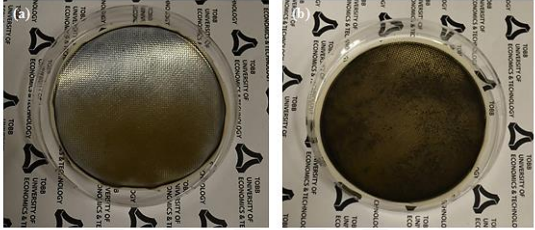
Şekil 3.1 Teflon üzerine üretilen Pt-Al alaşımlarının HCl ve \text{NaBH}_4 işlemlerinden (a) önceki ve (b) sonraki görüntüleri.
