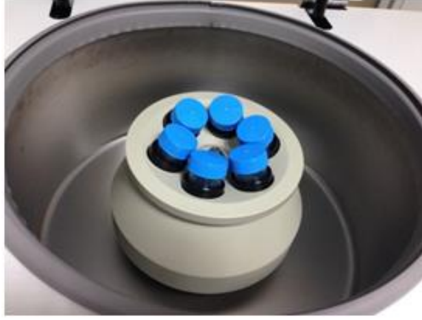
Şekil 2.23 Metiloranj foto degradasyonu için hazırlanan solüsyonların santrifüj cihazındaki görüntüsü.
