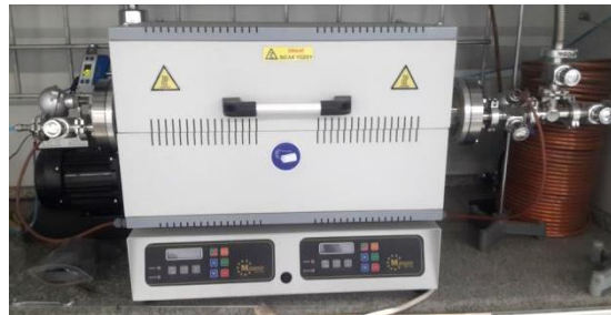
Şekil 4.1 Deneyde kullanılan Sülfürizasyon cihazının resmi.
