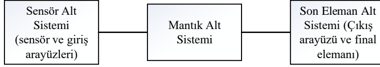
Şekil 4.3: Kontrol sistemi oluşturan alt sistemler.
