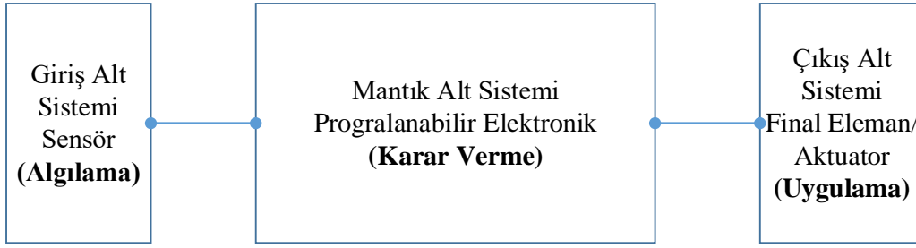
Şekil 1.1: Örnek Programlanabilir Kontrol Sistemi yapısı [3].
