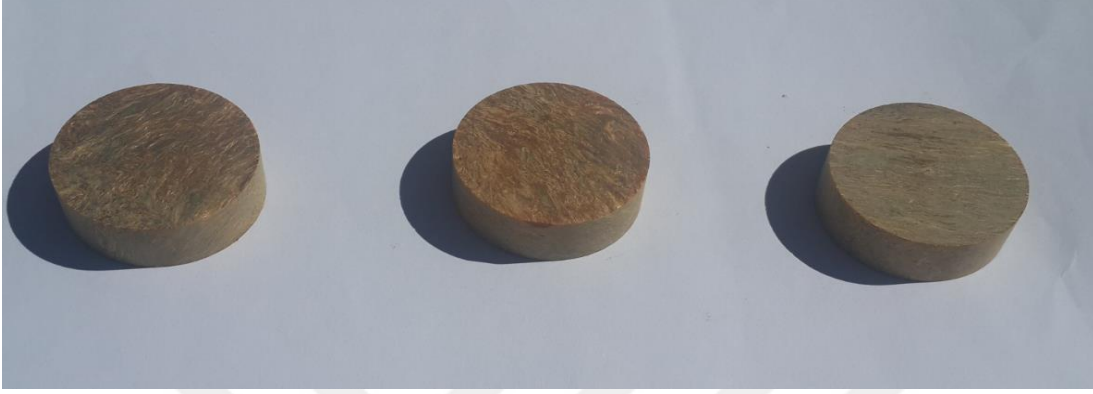
Resim 7.2 : Silika-fenolik test numunelerinin genel görünümü.
