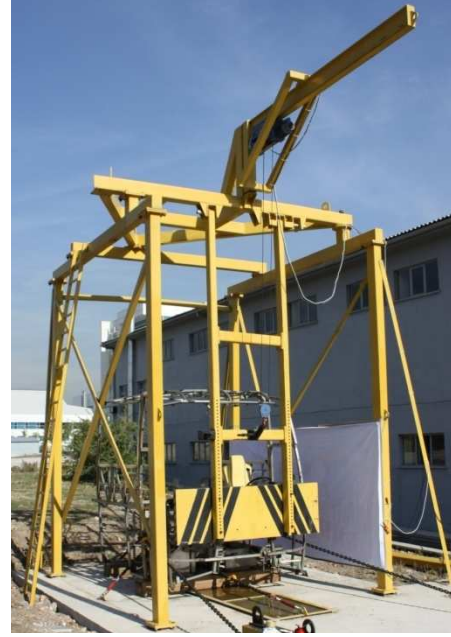
Şekil 9.1. Sarkaç test düzeneğinin genel görünümü.
