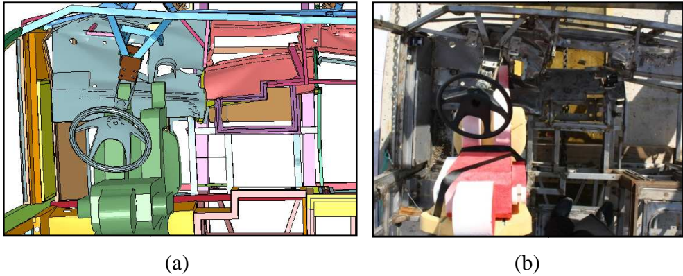
Şekil 9.11. Direksiyon sisteminin deformasyonu; (a) analiz, (b) test.
