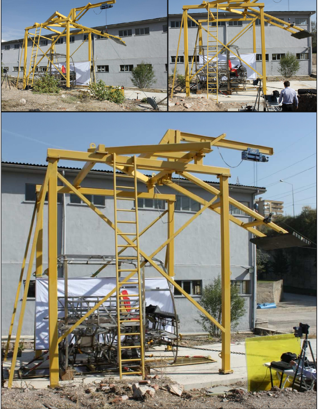
Şekil 9.6. Sarkaç testinin yapılış anı.
