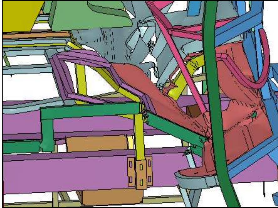
Şekil 9.14. Çarpışma sonucunda otobüs ön gövdesinde meydana gelen hasar.
