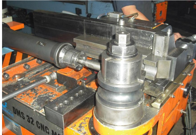
Şekil 1.1. Sayısal kontrollü (CNC) boru bükme tezgahı
