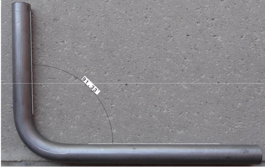
Şekil 4.3 Deney numunesi üzerinden yapılan geri yaylanma ölçümü. Malzeme: A573-81 65, Bükme açısı ( \theta ): 90^0 , bükme yarıçapı (R): 30 mm, boru çapı (D): 15 mm, boru et kalınlığı (t): 2 mm
