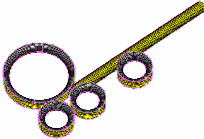
Şekil 5.1. Makaralı-itme boru bükme operasyonu bölüntülenmiş model
