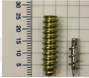
Şekil 5.8: Soldan sağa sırasıyla interferans vidası ve sütür ankor.
