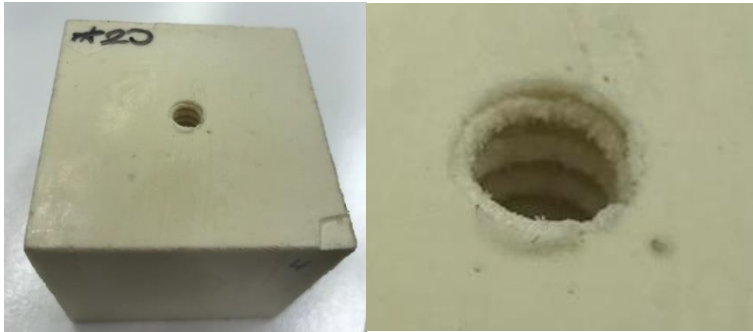
Şekil 6.3: Dış çekilmiş kılavuz deliği.
