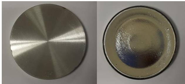
Şekil 3.18 Alüminyum hedef plakaların ilk kullanımdan önce ve son kullanımdan sonraki görüntüleri.
