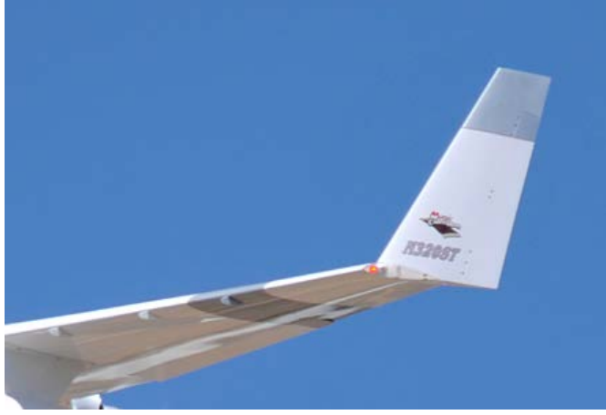
Resim 1.5: Orta hız uçaklarda kullanılan plaka tipi kanatçık (Rutan Long-EZ) [18]
