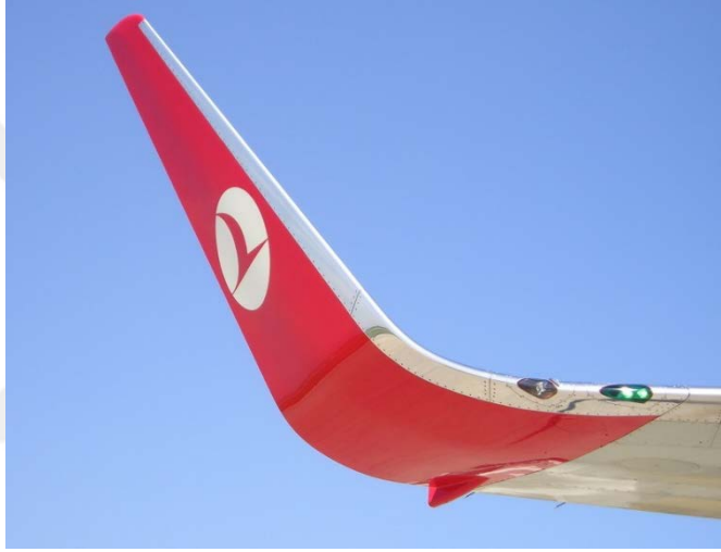
Resim 1.3: Yüksek hızlı jet ulaştırma uçaklarda kullanılan kıvrık tip kanatçık (Boeing-737) [14]
