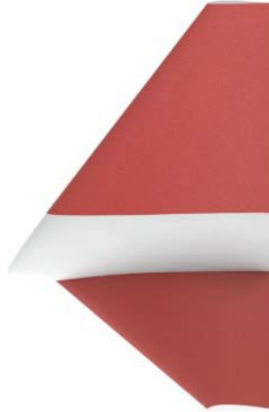
Şekil 4.8: Pala tipi (Scimitar) kanatçık
