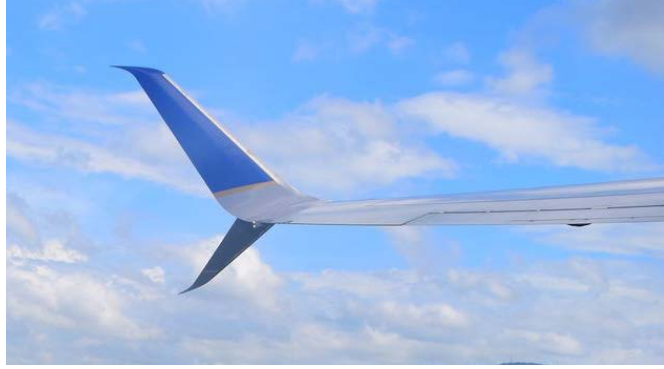
Resim 1.4: Pala tipi kanatçık (Boeing 737 MAX) [16]
