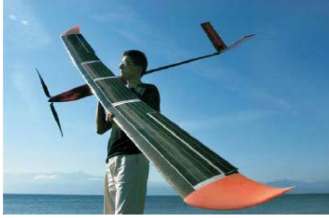
Resim 1.2: Düşük hızlı insansız hava aracı ve planörlerde kullanılan kıvrık tip kanatçık (Sky-Sailor) [13]
