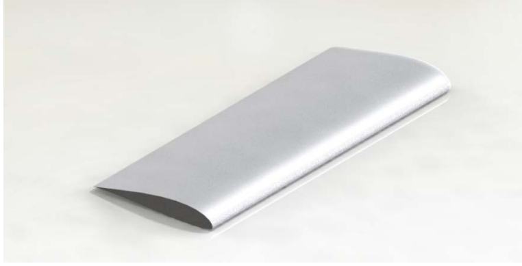
Şekil 4.5: 3B SD7062 yalın kanat katı modeli
