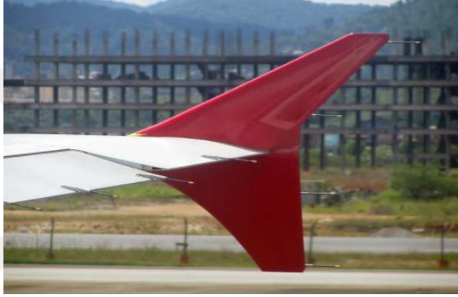
Resim 1.6: Yüksek hızlı uçaklarda kullanılan plaka tipi kanatçık (Airbus A320) [19]
