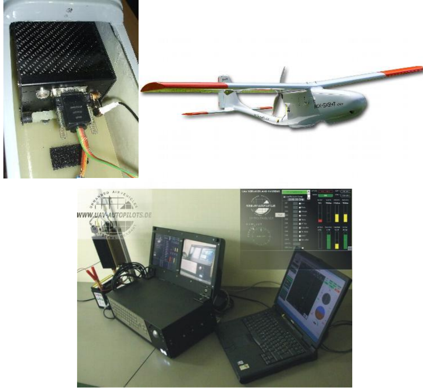
Şekil 1.4. DAP120 Otopilot ünitesi ( üst sol ), mX-SIGHT İHA platformu ( üst sağ ) ve sistemin yer kontrol istasyonu [10]
