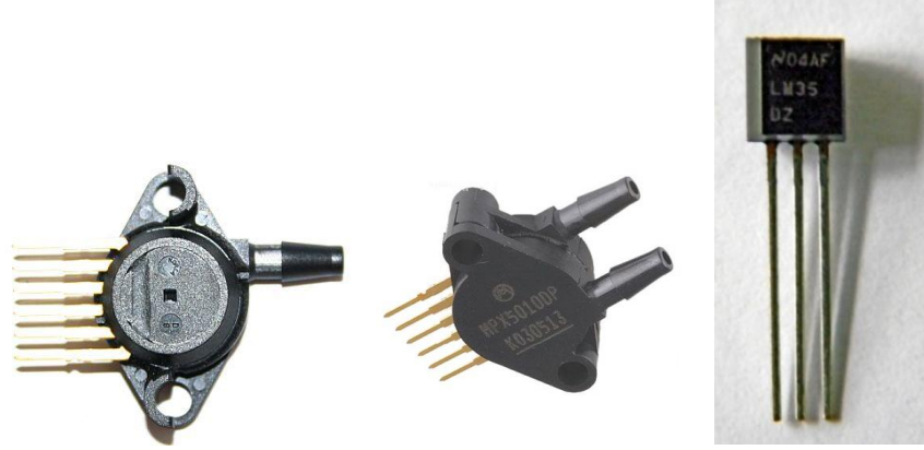
Şekil 2.4. Sistemde kullanılan mutlak basınç sensörü ( solda ), fark basınç sensörü ( ortada ) ve sıcaklık sensörü [23]
