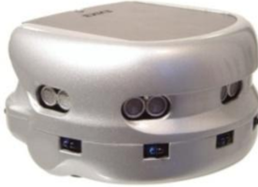
řekil 2.1. KheperaIII mini gezgin robotu.
