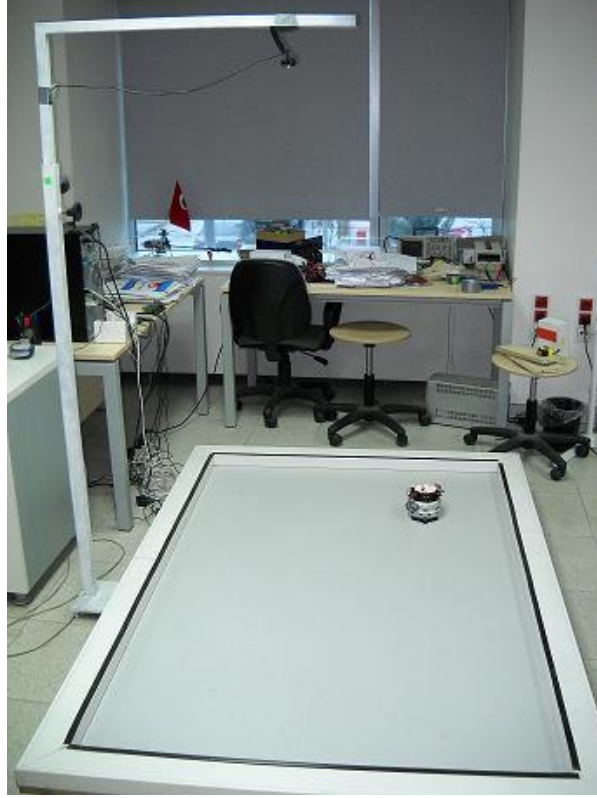
Şekil 2.3. Güzergâh takibi için tepe kamerası bulunan deney düzeneği.
