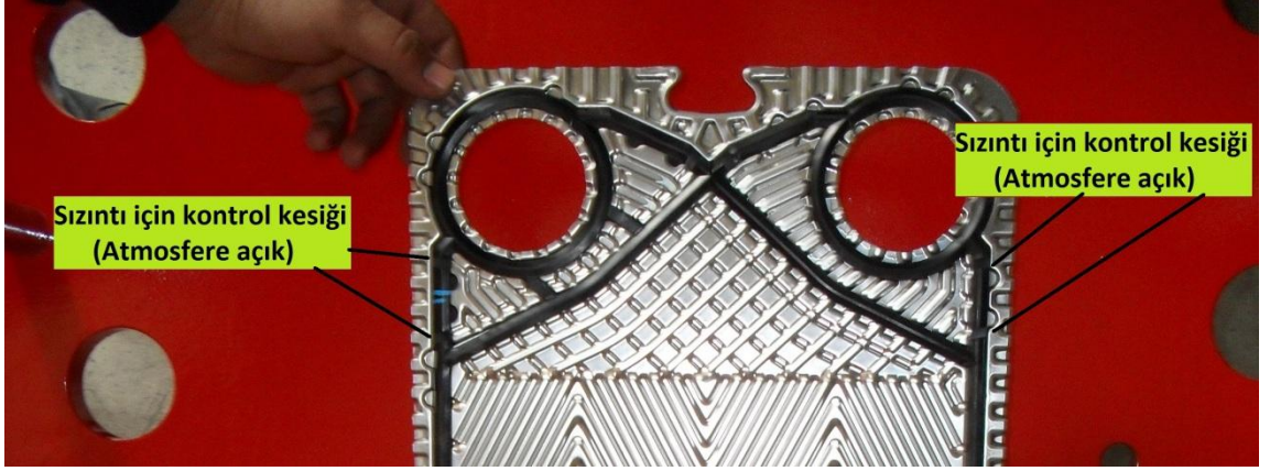
Őekil 1.10. Conta üzerinde sızdırma kontrol kesikleri (İlk plaka üzerinde gösterilmiştir.)
