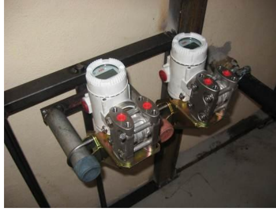
Şekil 2.15. Deney düzeneğinde kullanılan fark basınçölçer
