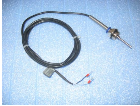
Şekil 2.8. Deneylerde kullanılan J tipi termočift ve yapılan adaptör
