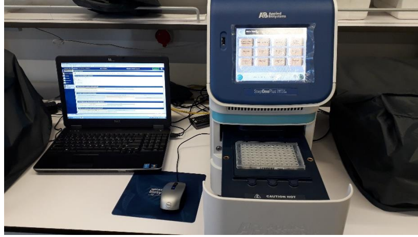
Şekil 2.10 : Applied Biosystems, StepOnePlus Real-Time PCR Sistemleri ve cihaza uygun 96 kuyucuklu plaka.
