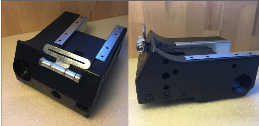
Resim 5.8: AATS ana gövdesine sac büküm parçalarının montajı.
