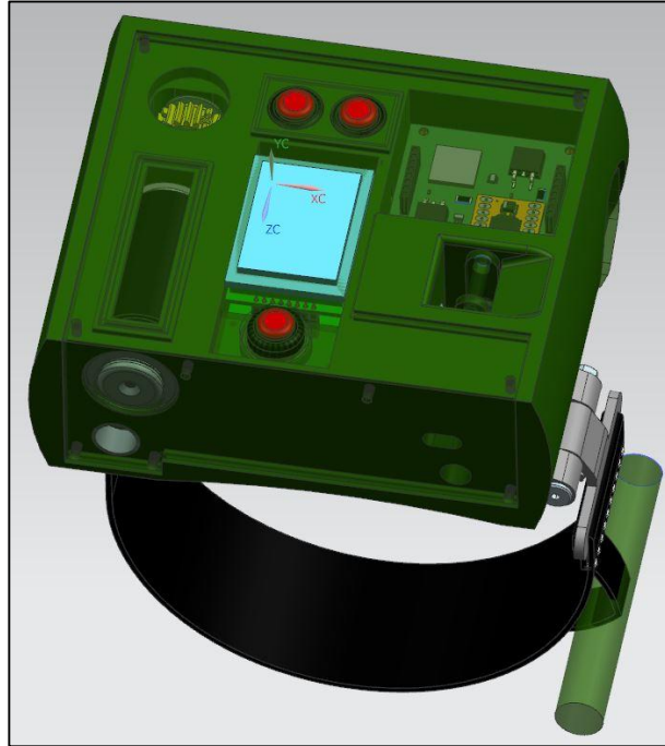
Şekil 3.16: Kemer kilitli turnike sistemi dördüncü versiyon transparan görünüm.
