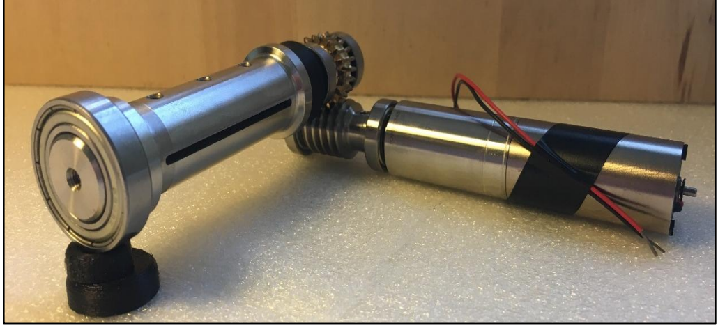
Resim 5.5: AATS sonsuz dişli mekanizmasının montajı.
