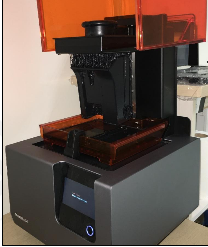
Resim 5.1: AATS ana gövdesinin üç boyutlu yazıcı ile ürettirilmesi.
