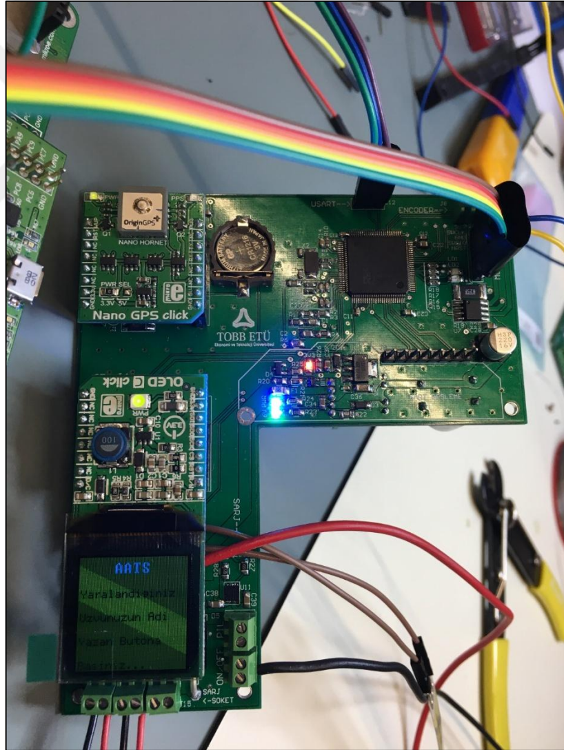
Resim 4.6: AATS üretilen PCB ye gömülü yazılım yüklenmesi.
