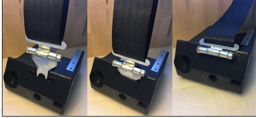
Resim 5.9: AATS kemer kilit sistemi montajı.
