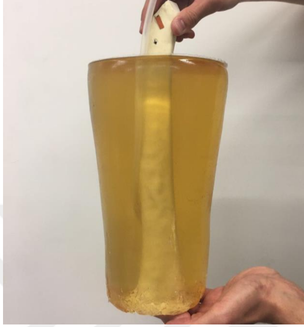
Resim 5.7 : Üretilen alt ekstremite fantomu
