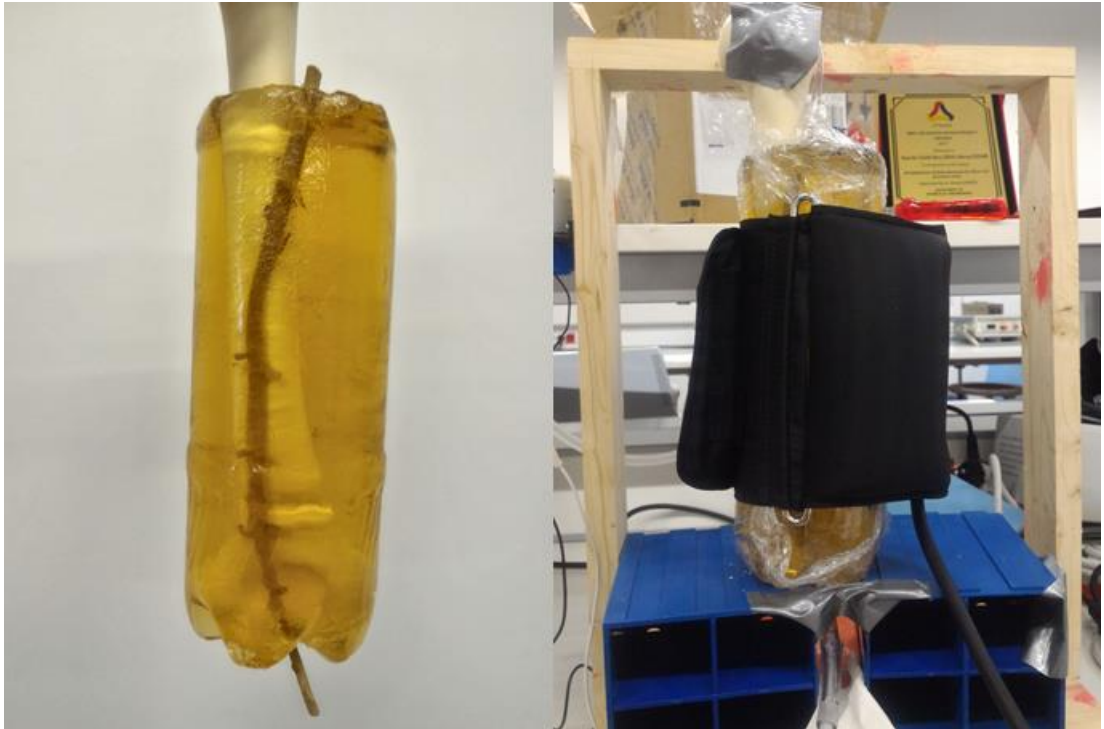
Resim 5.11 : Turnike işlemi uygulanan üst ekstremite fantomu
