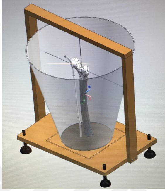
Resim 5.5 : Siemens NX programıyla tasarlanan düzenek
