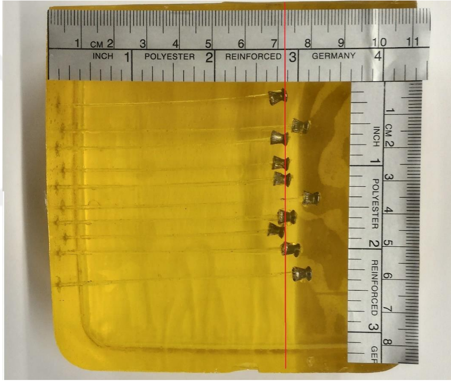
Resim 5.3 : Saçmaların %10 derişimdeki balistik jelatine girme miktarları
