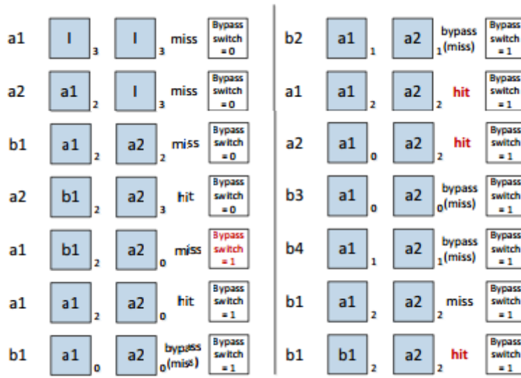
Şekil 2.6 : 2 Yollu L1 önbellek atlama örneği
