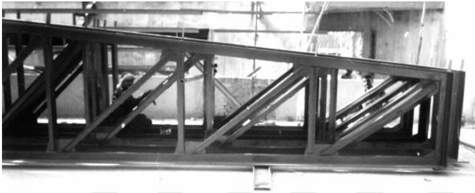
Şekil 1-7: Tabu Arama ve Genetik Algoritma ile Eniyilenen Çatı İskelet Yapısı [11]
