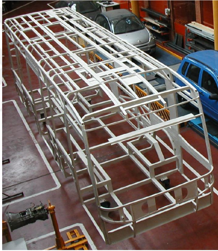
Şekil 1-6: Genetik Algoritma ile Eniyilenecek Otobüs Karkas Yapısı [9]
