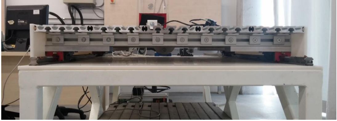
Şekil 2.3 : Raylar, doğrusal kızaklar ve hareketli platform.
