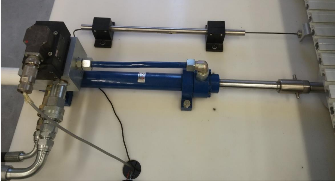
Şekil 2.5 : LVDT ve hidrolik eyleyici.
