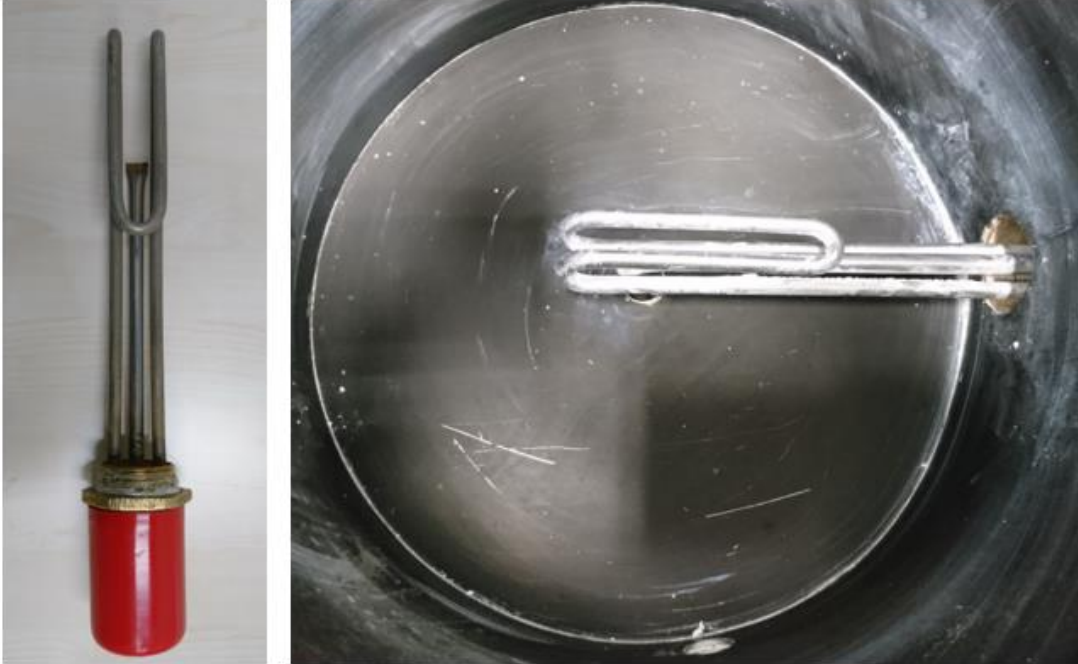
Resim 2.12. Deney düzeneğinde ısıtıcı olarak kullanılan 2 kW gücündeki elektrikli ısıtıcı
