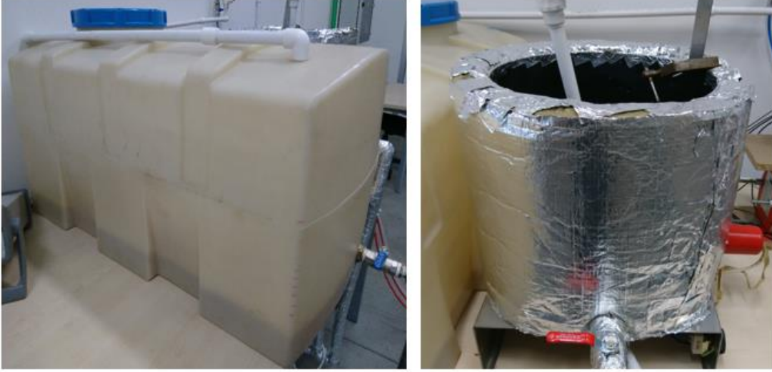
Resim 2.4. Deney tesisatında kullanılan soğuk ve sıcak akışkan depoları
