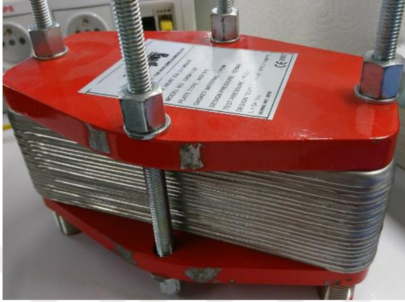
Resim 2.3. Deneylerde kullanılan contalı plakalı ısı değıştirgeci
