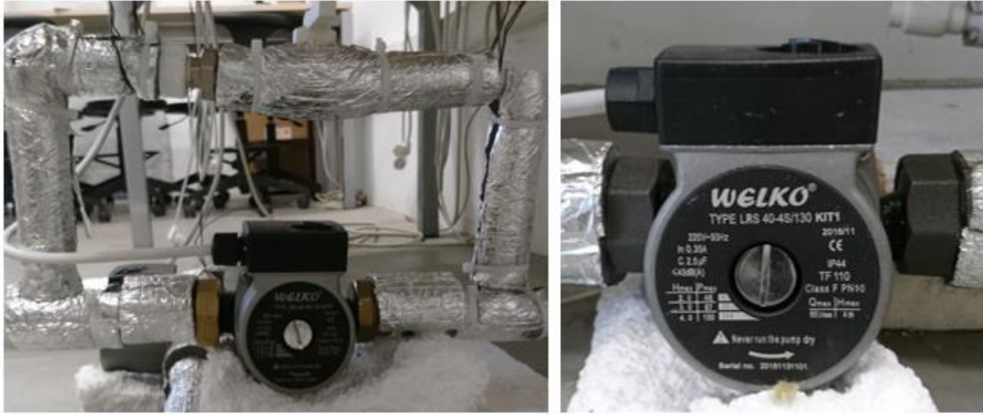
Resim 2.5. Deney düzeneğinde kullanılan pompalar ve by-pass hattı
