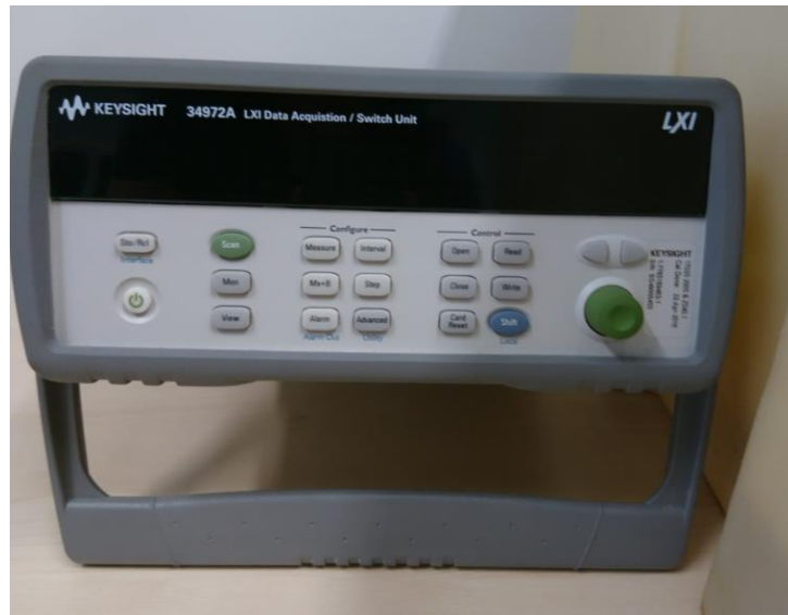
Resim 2.10. Deneylerde kullanılan veri toplayıcısı
