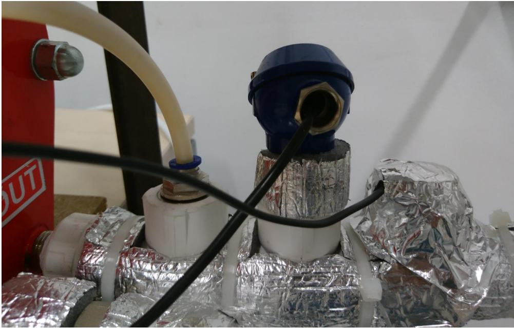
Resim 2.8. Plakalı ısı deėiřtirgecinin giriř ve ıkıřındaki ısıl iftlerin ve basın fark lerlerin yerleřimi
