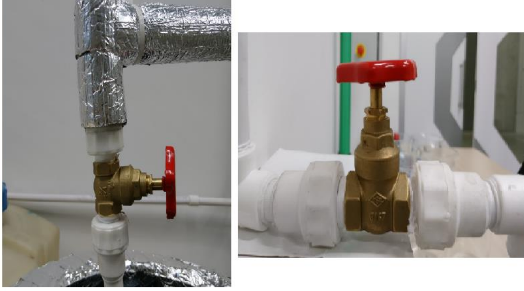
Resim 2.11. Deney düzeneğinde akışkan debilerini ayarlamak için kullanılan sürgülü vanalar
