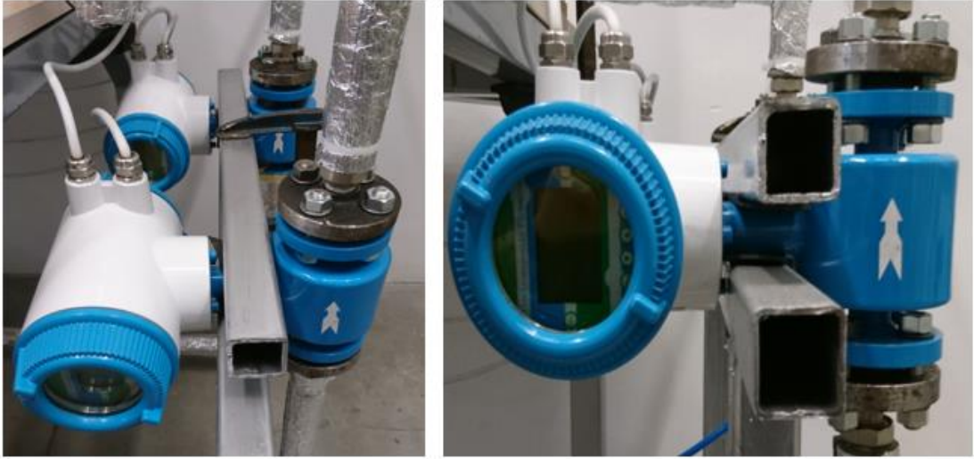
Resim 2.6. Deney düzeneğinde kullanılan elektromanyetik debimetreler
