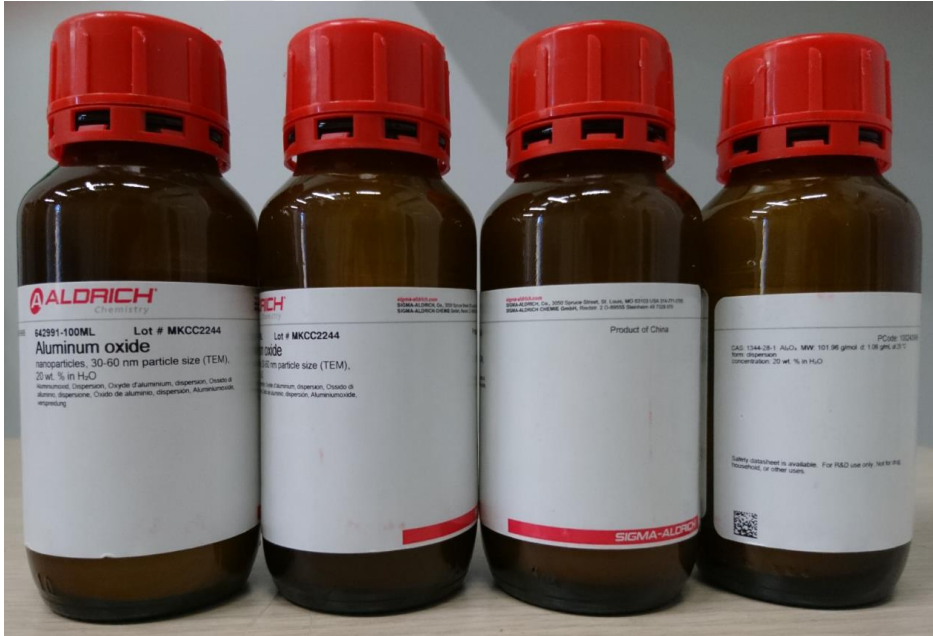
Resim 3.1. Sigma-Aldrich firmasından alınan Al_2O_3 /su nanoakışkanları
