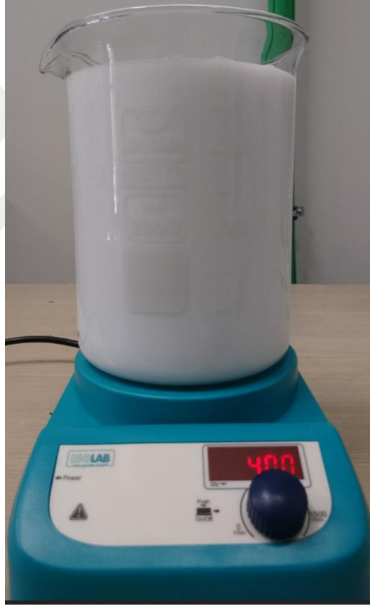
Resim 3.2. Konsantrasyon ayarlanırken kullanılan manyetik karıştırıcı
