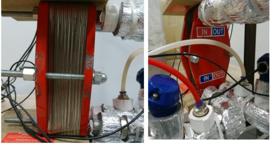
Resim 2.9. Deney düzeneğinde kullanılan plakalı ısı deęiřtirgeci
