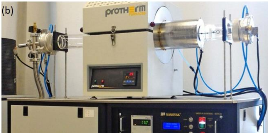
Şekil 3.5: Kuvars tüplü fırının (a) sisteminin şematik gösterimi ve (b) fotoğrafı.
