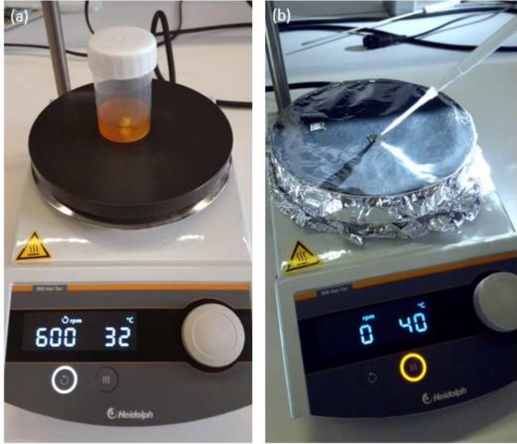
Şekil 3.3: (a) Kapaklı PP kap içindeki \text{Fe}(\text{NO}_3)_3 \cdot 9\text{H}_2\text{O} -etanol solüsyonunun 600 rpm devirde manyetik balıkla karıştırılırken ve (b) alüminyum folyo ile sarıldıktan sonra sıcaklığı 40^\circ\text{C} 'ye ayarlanmış ısıtıcı plaka üzerine yerleştirilmiş SiC alttaşına mikropipetle 1 \mu L solüsyon uygulanırken çekilmiş fotoğraflar.
