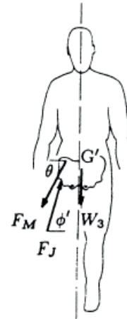
Şekil 5.32 Sorunun üç kuvvetli bir sisteme indirgenmiş formu
