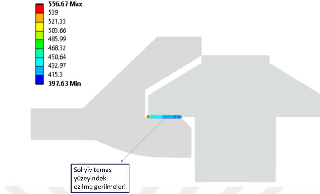
Şekil 3.38: İkinci flanş bölgesi sol yiv temas bölgesi ezilme Von Mises gerilmeleri [MPa].
