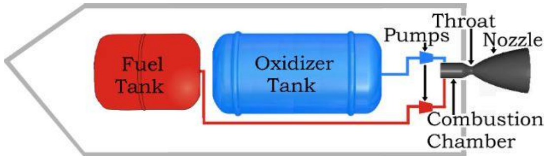
řekil 1.1 Sıvı Yakıtlı Roket Motoru Temel Bileřenleri
