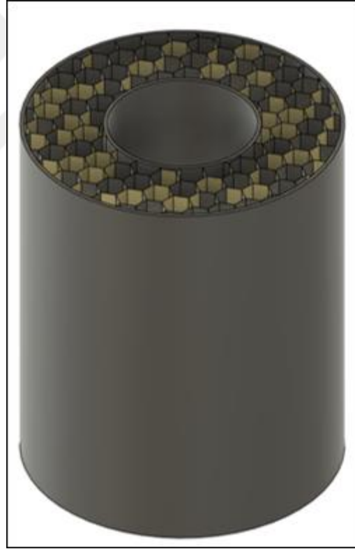
Şekil 3.1: Örnek Hibrit Enerji Sönümleyici Yapı
