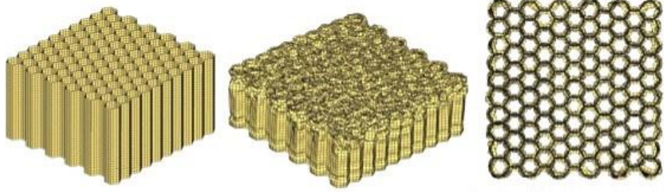
Şekil 2.10: Bal Peteği Yapısının Deformasyon Modları [10].
