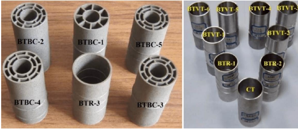
Şekil 2.46: Üç farklı biyo ilhamlı enerji sönümleyici profil [54].
