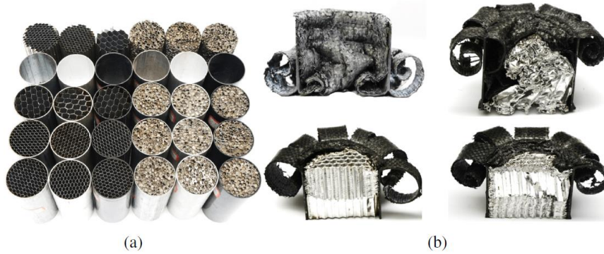
Şekil 2.21: Ezilme testinden önce numuneler (a) ve içi bal peteği dolu CFRP tüplerin (b) ezilme sonuçları [28].
