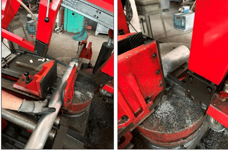
Şekil 4.2: Testere ile aluminyum boru profil kesimi.
