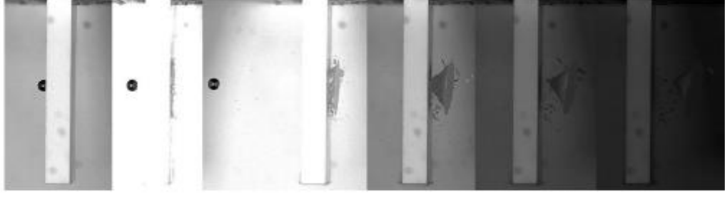
Şekil 2.9: Toussaint'ın çalışmasında 13 mm alümina plaka üzerinde 200 m/s hızla gerçekleştirilen çarpışmanın görüntüleri [42].
