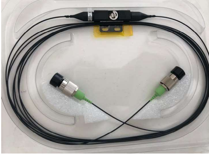
Resim 3.3: 1550 nm merkez frekansında 5 nm genişliğinde optik filtre
