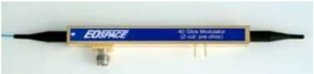
Resim 3.6: Optik Modülör (Mach Zehnder Mod.)
