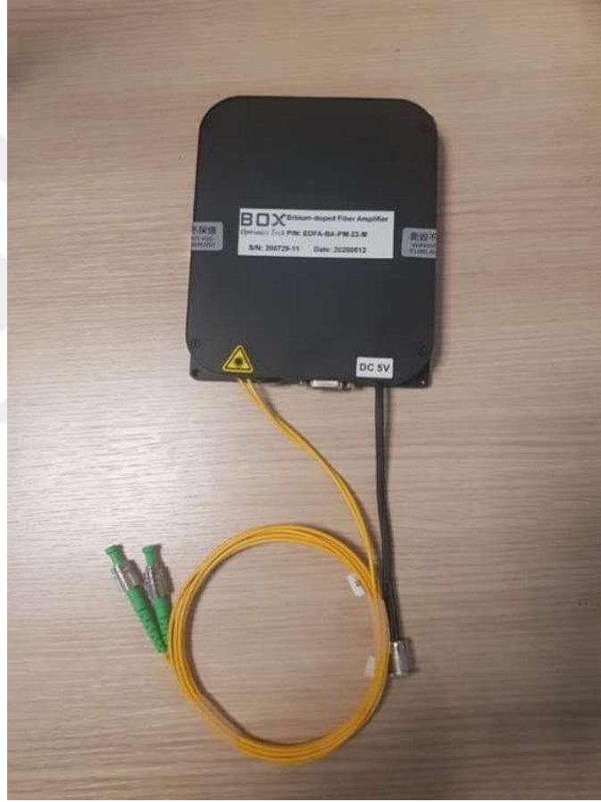
Resim 3.2: 200mW Çıkış Gücünde Erbiyum Tabanlı Fiber Optik Yükselteç
