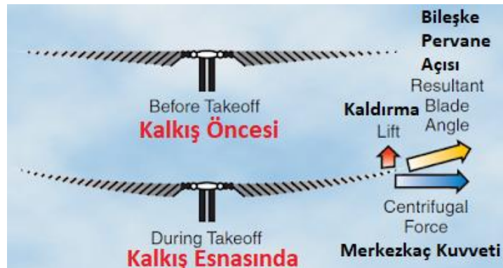
Şekil 3.9 : TPP, ana rotor dönme düzleminin konikleşmesi (Coning).
