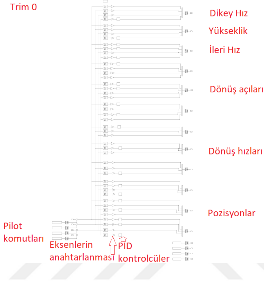
Şekil 5.48 : Trim 0' daki PID' lerin yerleşimi.
