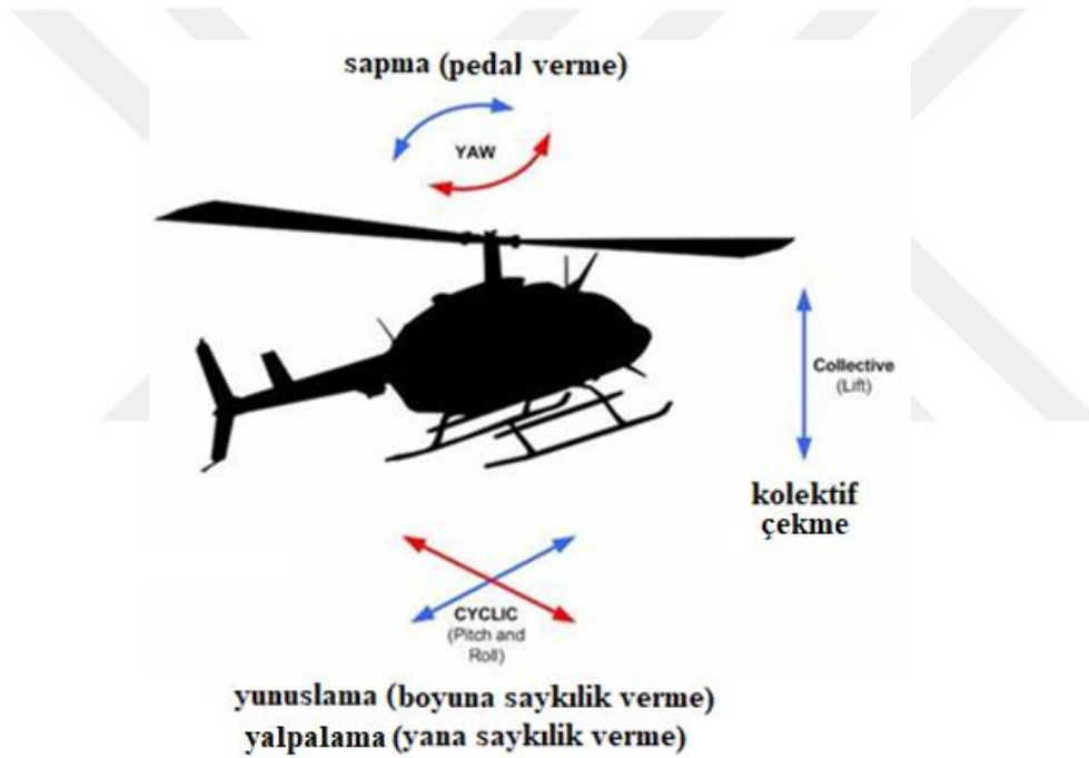
Şekil 3.6 : Helikopter uçuş kontrol manevraları: yunuslama, yalpalama, sapma ve kolektif.
