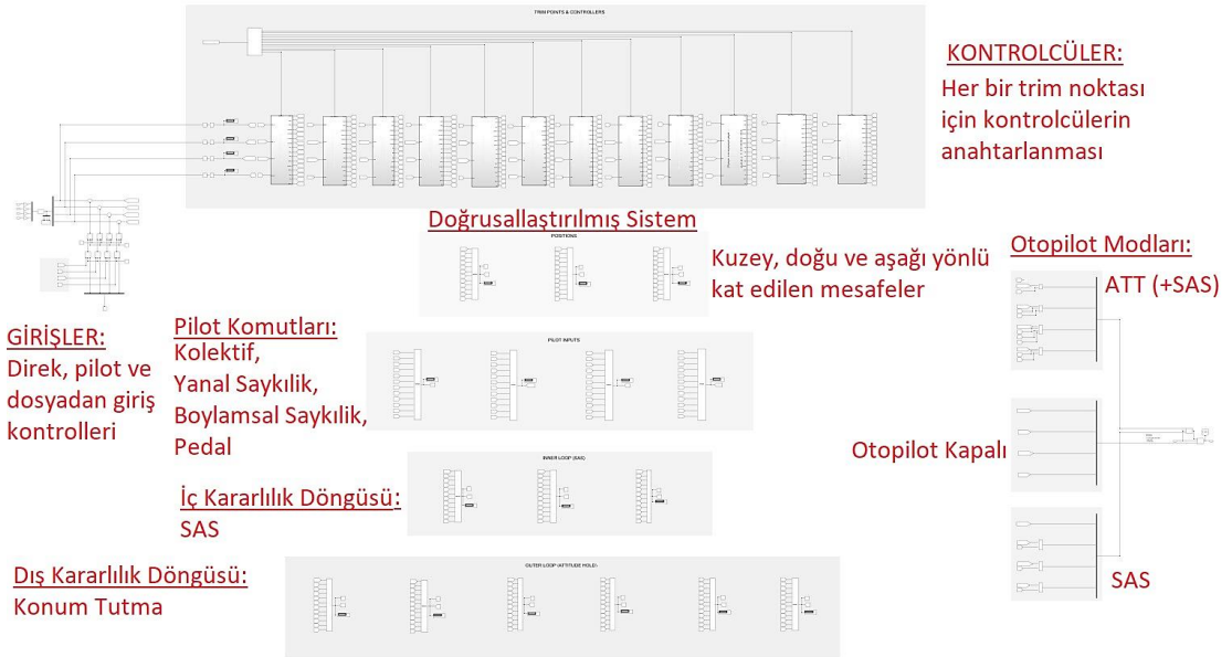
Şekil 5.39 : Otomatik Uçuş Kontrol Sistemi İç Yapısı.
