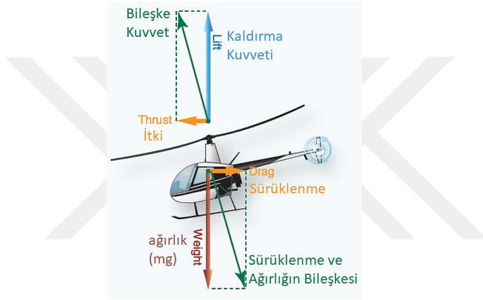
Şekil 3.18 : İleri uçuş (Forward flight).
