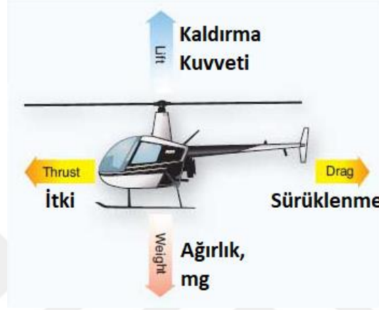
Şekil 3.4 : Helikopter üzerine etkiyen 4 ana kuvvet.
