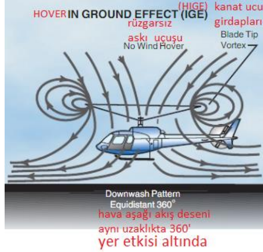
Şekil 3.12 : Yer-etkisinin içinde askı uçuşu (HIGE).
