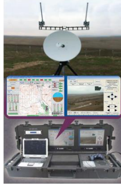
Şekil 2.5 : ARI-1T' nin yer kontrol istasyonu (YKİ).
