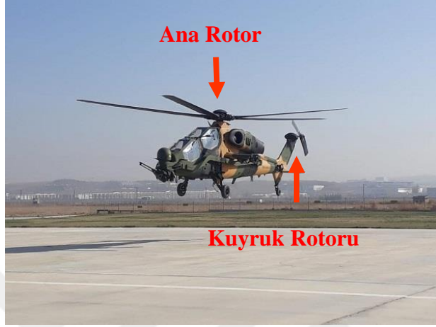
Şekil 3.1 : Konvansiyonel kuyruk rotorlu bir helikopter, T129 ATAK [23].
