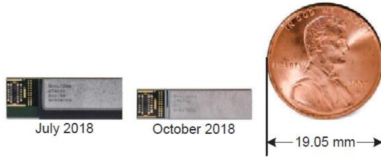
Şekil 1.2 : Bir Cent ile 2 QTM052 Milimetre Anten Modülünün Karşılaştırılması. [24]
